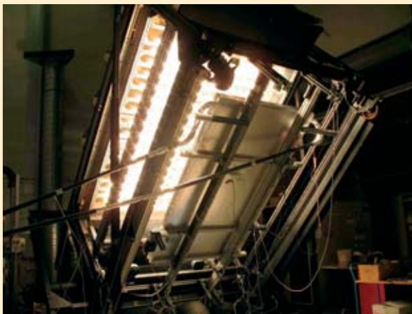
Abb. 18 Stagnationsuntersuchungen mit Sonnensimulator Foto: ISFH, Hameln
